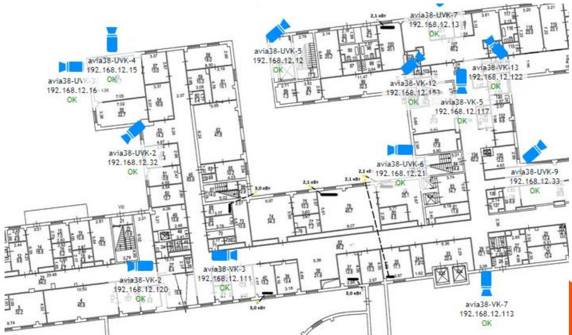
Составление физической карты и размещение объектов мониторинга, упрощает понимание размещения объектов и время реагирования на исправление аварийных ситуаций. В систему «Camkeeper» можно добавить подложки с планом помещения или территории и расставить объекты мониторинга.
